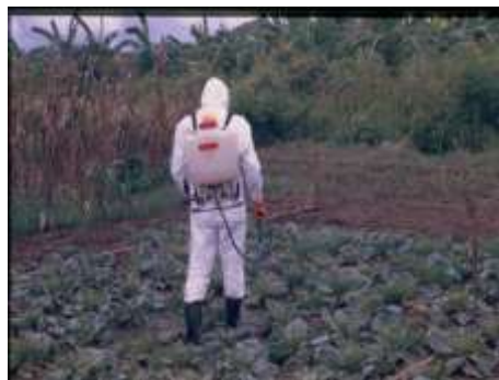
ภาพที่ 10 เครื่องพ่นสารแบบเครื่องพ่นสารแบบสบูโยกสะพายหลัง
