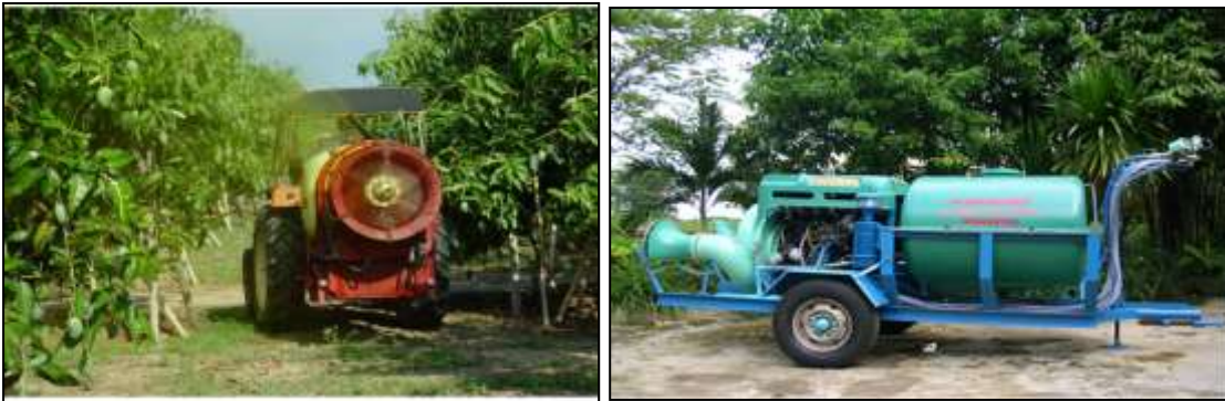
ภาพที่ 14 เครื่องยนต์พ่นสารแบบใช้แรงลมขนาดใหญ่ เครื่องยนต์พ่นสารแบบแอร์บลาสท์ (ซ้าย) และแบบแอร์เชียร์ (ขวา)
