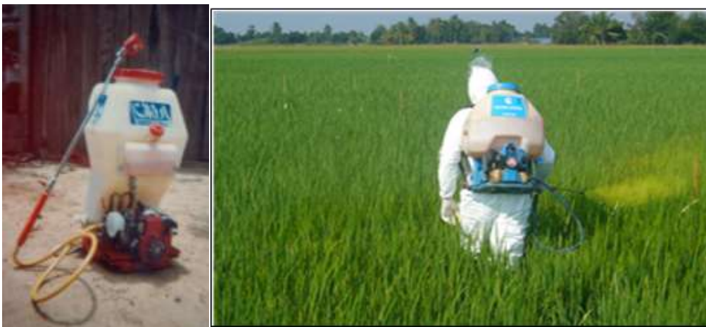
ภาพที่ 11 เครื่องยนต์พ่นสารสะพายหลังแบบใช้แรงดันน้ำ
